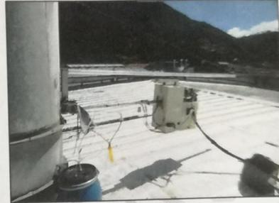
No 2. Tren de muestreo en la chimenea de la Torre de Secado de Pulverización
