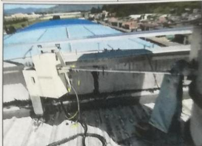
No 1. Tren de muestreo en la chimenea de la Torre de Secado de Pulverización
